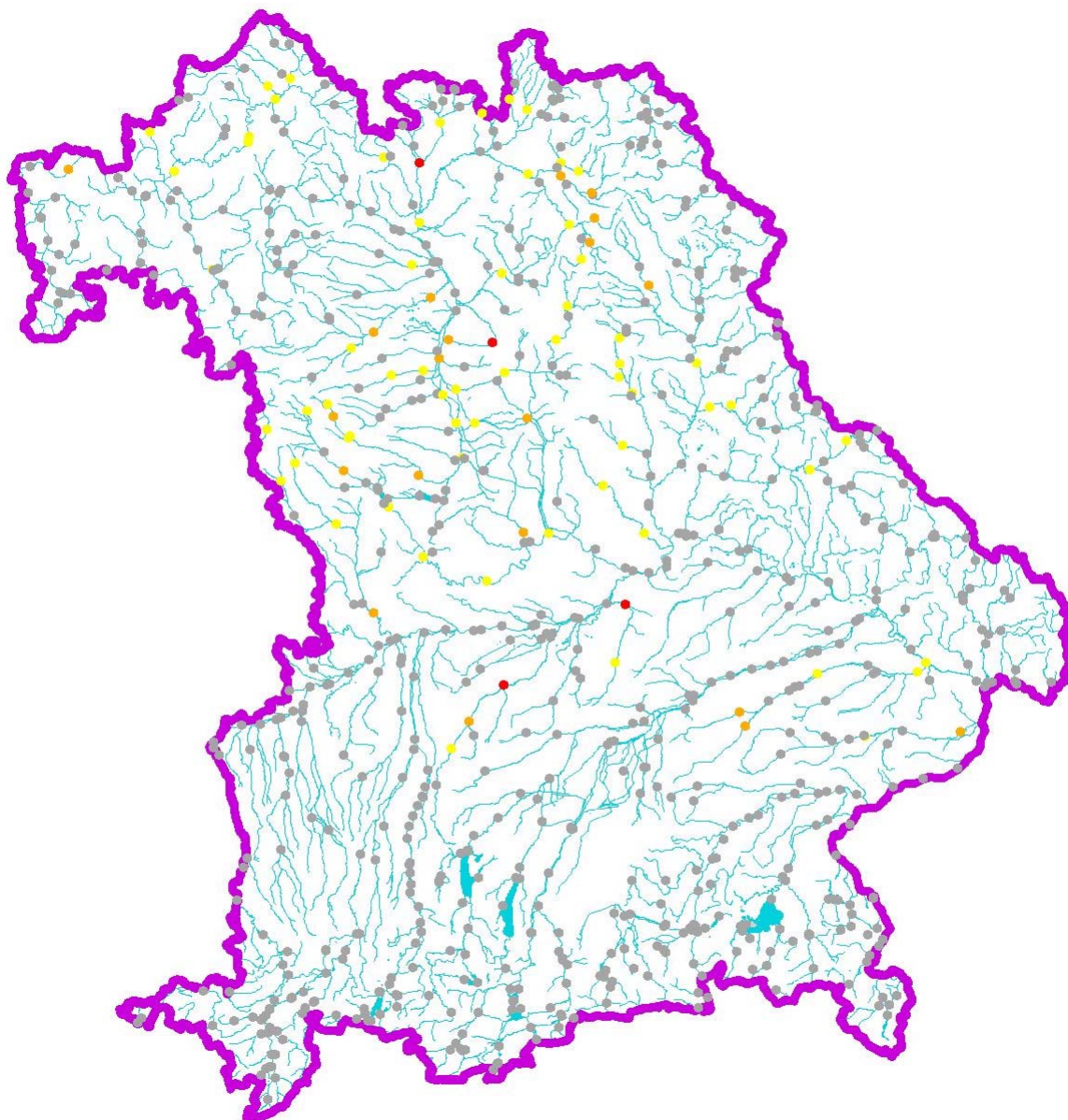
Abb. 1: Die Übersicht zeigt die an den bayerischen Pegeln innerhalb des Monats März erreichte höchste Meldestufe (Meldestufe 1: gelb; Meldestufe 2: orange; Meldestufe 3: rot).
